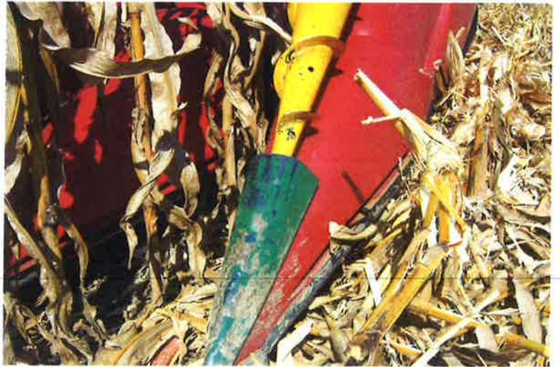
**HYDRAULICALLY DRIVEN END CONES
